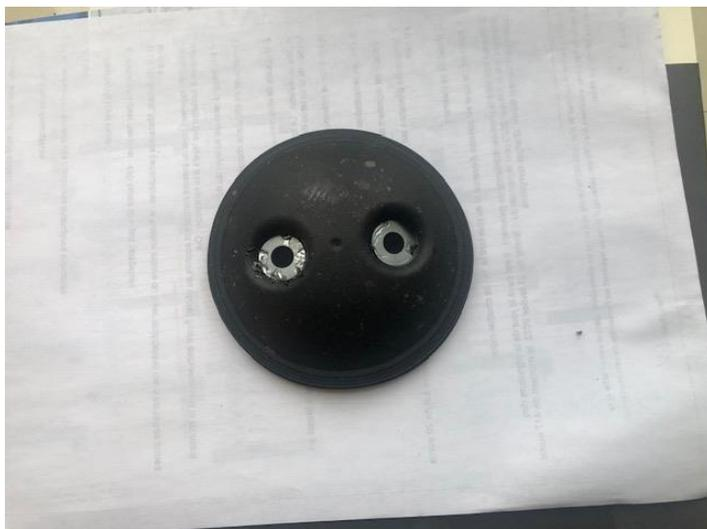
**Piège seul** : rondelle métallique de diamètre de 8mm intérieur
