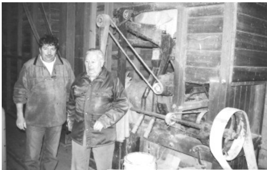
Guy et son fils devant l'appareil de nettoyage du grain comprenant : un émotteur, une aspiration, un trieur à graines rondes, une brosse à blé, une brosse et toile épointeuse et aimant.
